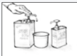
Figur 2 Doser de rigtige dele resin og hærdere.
