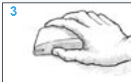
Figur 8 Slib ikke-porøse overflader. Lav en grunding, som epoxyen kan fæstne sig til.
