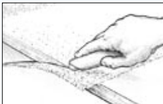
Figur 25 Afskær overskydende glasfiberdug, når epoxyen har fået geleagtig konsistens, men før den hærder og bliver hård.
