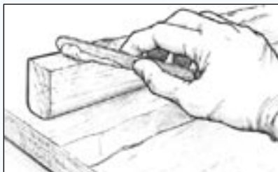
Figur 10 Påfør fortykket epoxy på en af limfladerne
