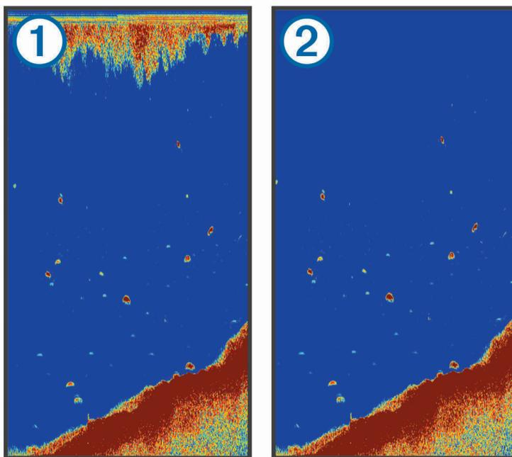
Overflatestøy ① forårsakes av interferens mellom svingeren og vannet. Du kan skjule overflatestøy ② for å redusere forstyrrelser. Bredere strålebredder (lavere frekvenser) kan vise flere objekter, men kan skape mer overflatestøy.
