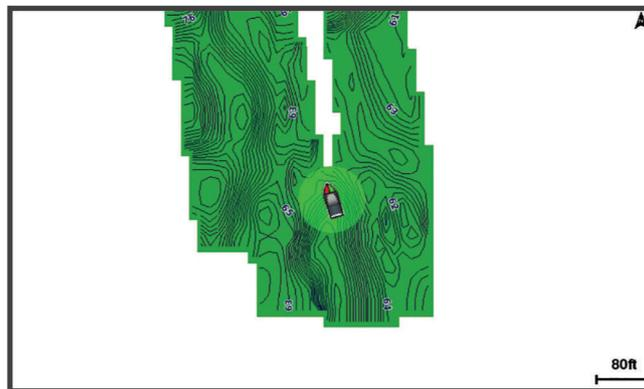
En grønn sirkel indikerer god dybde og GPS-posisjon og en hastighet under 16 km/t (10 mph). En gul sirkel indikerer god dybde og GPS-posisjon og en hastighet mellom 16 og 32 km/t (10 og 20 mph). En rød sirkel indikerer dårlig dybde eller GPS-posisjon og en hastighet over 32 km/t (20 mph).
