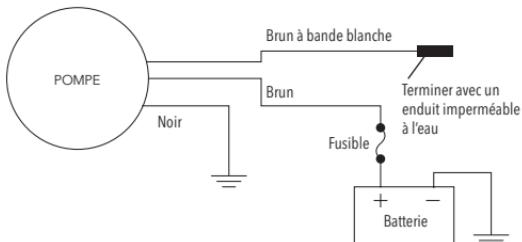
**Pour pompe 12 volts:** Tension minimum requis de 10,5 volts.
