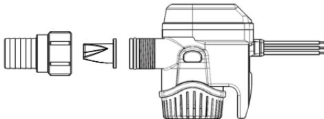
Ta regelbundet bort, rengör och inspektera länspump, backventil och området omkring så att där inte finns skador eller smuts, som kan försämra pumpens prestanda.
