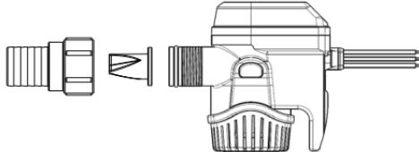
Rimuovere, pulire ed ispezionare periodicamente la pompa di sentina, la valvola di sfato e lo spazio circostante per rilevare danni e presenza di residui che potrebbero ridurre le prestazioni della pompa.
