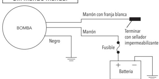
**Para la bomba de 12 voltios:** Voltaje mínimo requerido de 10,5 voltios.
