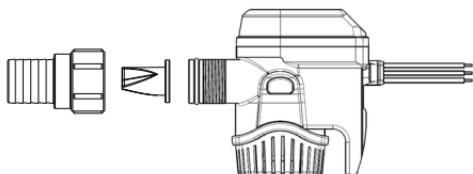
Enlever, nettoyer et inspecter périodiquement la pompe d'assèchement, le clapet antirétour et la zone environnante pour être certain qu'il n'y ait aucun dommage ou débris pouvant réduire le rendement de la pompe.
