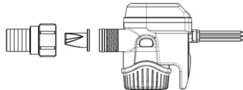
Desmonte, limpie e inspeccione la bomba de sentina, la válvula de retención y sus alrededores por si tuviesen daños o suciedad que pudieran reducir el rendimiento de la bomba.
