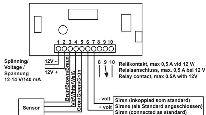
**SE KOPPLINGSSCHEMA GASFINDER 1 – FJÄRRAVSTÄNGNINGSVENTIL**
